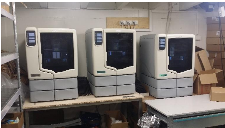
Figur 2. 3D-printing av komponenter i plastmateriale hos Curio.
